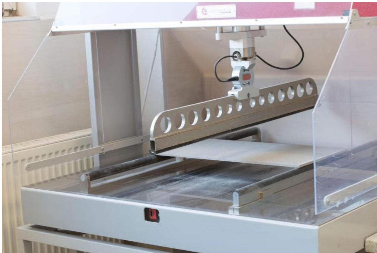
Maszyna do badania płytek na odporność na zginanie.
