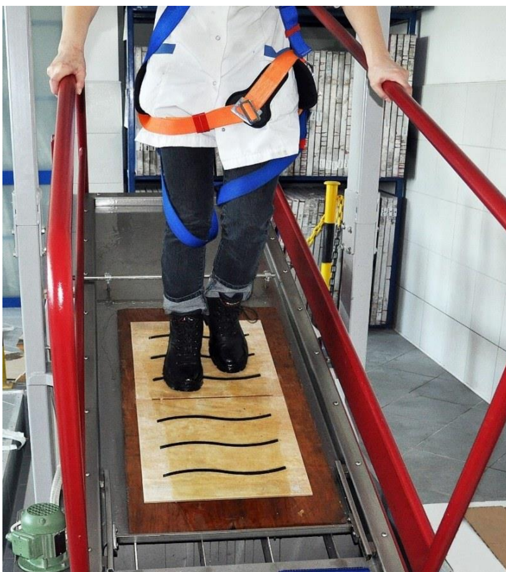
Badanie antypoślizgowości przy wykorzystaniu platformy z pochylnią
